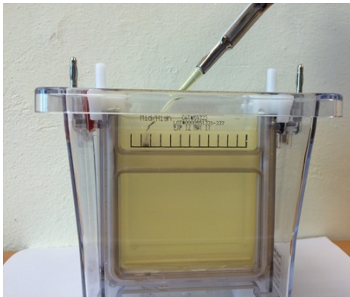
Рис.1.2. Нанесение образцов на гель для SDS-электрофореза
