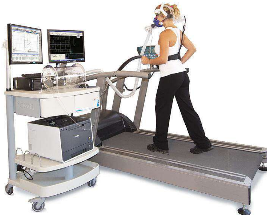
Рис. 3.5. Система вимірювання метаболізму, що використовується під час фізичних вправ. Непряма калориметрія [14].
