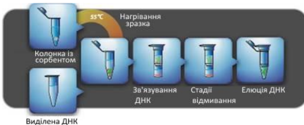
Рис. 2. Скорочена схема твердофазного виділення ДНК на основі силікатного сорбента (адаптовано з explorer.bio-rad.com). Пояснення в тексті.
