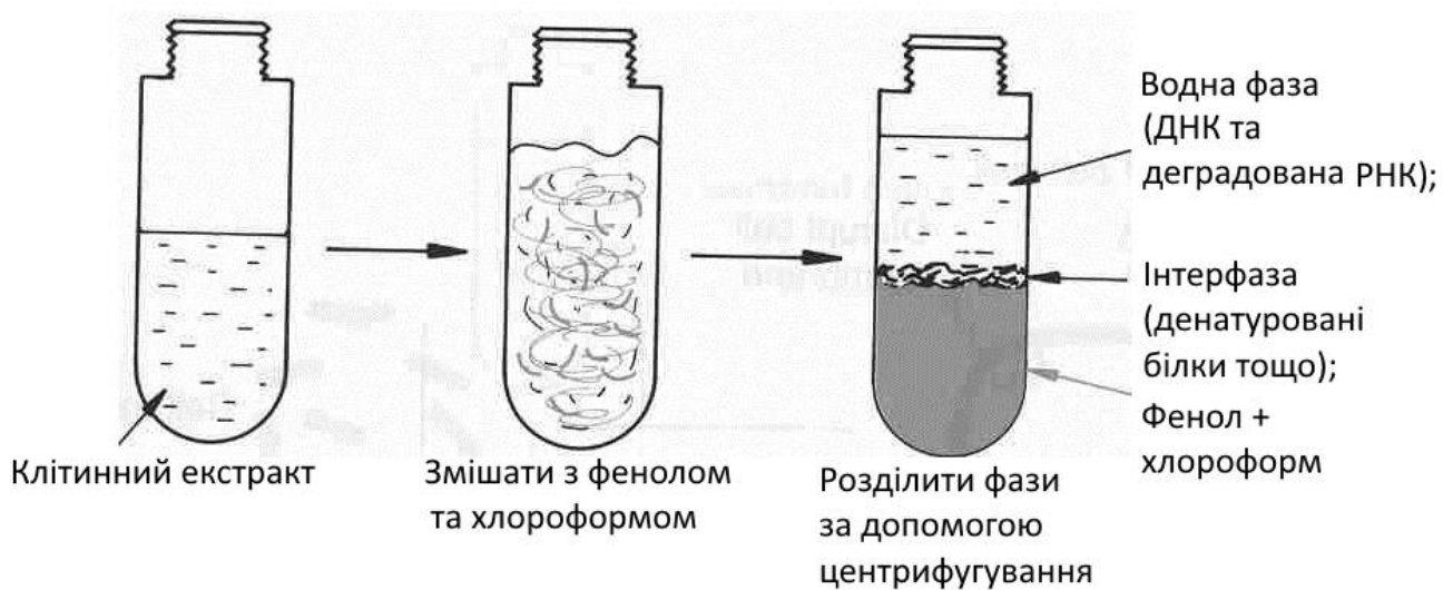
Рис. 31. Розподіл фаз в еппендорфі після центрифугування (запозичено з Sambrook, J., Fritsch, E.F., Maniatis, T. Molecular cloning: a laboratory manual).
