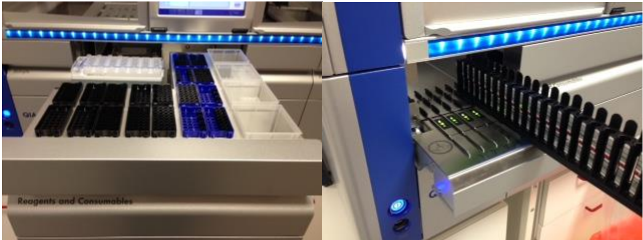
Рис. 3. Роботизована станція для виділення нуклеїнових кислот на основі магнітної сепарації (комірки для завантаження зразків; «Qiagen QiaSymphony SP», The Jenner Institute Laboratories (запозичено з http://www.jenner.ac.uk/qiasymphony-automated-nucleic-acid-extraction-qane ).
